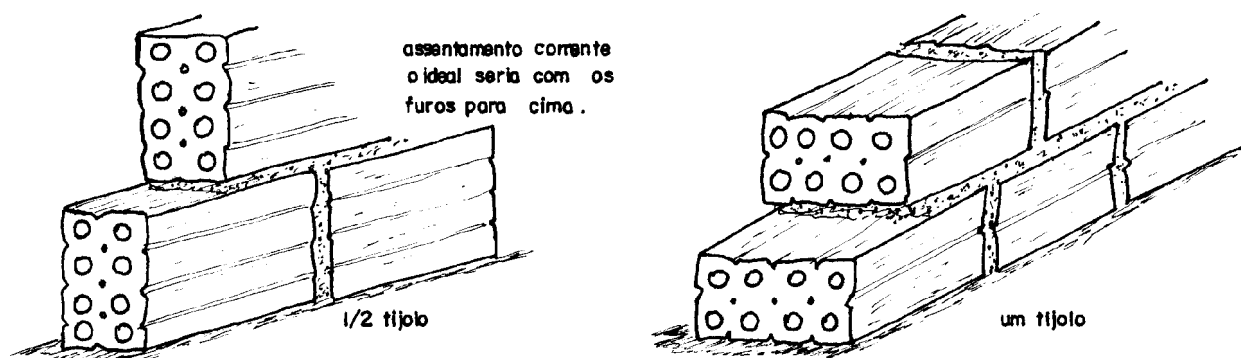
Figura 1 - Execução de alvenaria utilizando tijolos furados.
